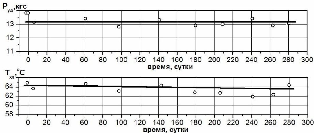
Рис.9. Зависимость силы удара сферического сегмента ( $P_{уд}$ ) о препятствие (силоизмеритель) и  $T_{хл}$  от длительности вылеживания при температуре  $(-15) \pm 2^\circ\text{C}$ . Сплав Ti-50,0at%Ni
