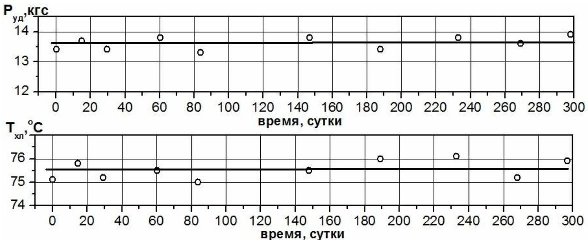
Рис.6. Зависимость силы удара ( $P_{уд}$ ) сферического сегмента о силоизмеритель и температуры взрывного скачка сегмента с хлопком ( $T_{хл}$ ) от длительности вылеживания при температуре  $20\pm 2^\circ\text{C}$ . Сплав Ti-50,0at%Ni
