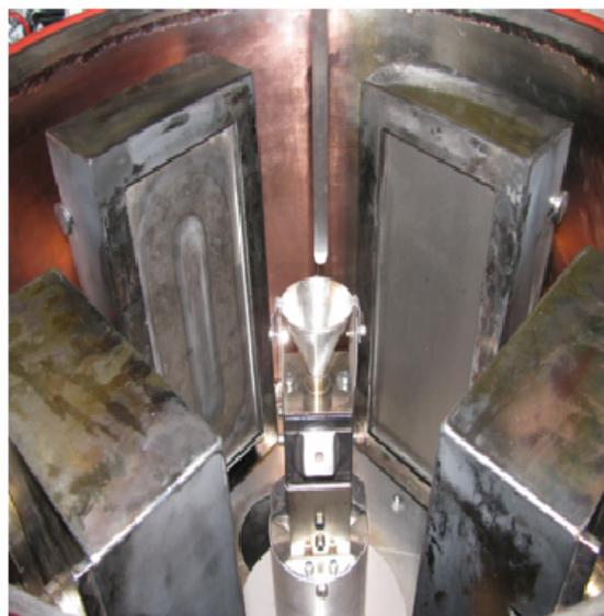
Рис.1. Камера PVD аппарата: схема расположения четырех магнетронов в камере, внутренний вид камеры аппарата
