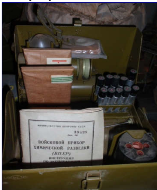
Рис. 7. Войсковой прибор химической разведки (ВПХР): 1 - ручной насос; 2 - плечевой ремень с тесьмой; 3 - насадка к насосу; 4 - защитные колпачки для насадки; 5 - противодымные фильтры; 6- патрон грелки; 7 - электрический фонарь; 8 - корпус грелки; 9 - штырь; 10 - лопатка; 11 - индикаторные трубки в кассетах
