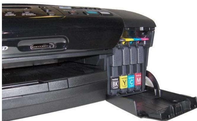
**Рисунок 197 – Принтер с отдельными картриджами**
