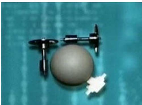
**Рисунок 145 – Устройство механической мыши**
