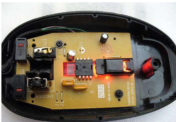
**Рисунок 148 – Состав оптической мыши**
