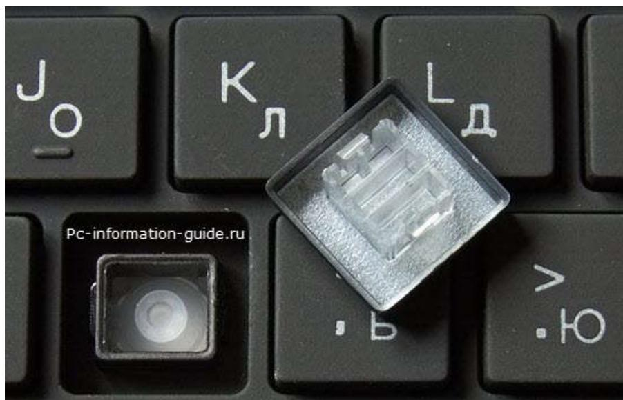
Рисунок 133– Устройство клавиатуры
