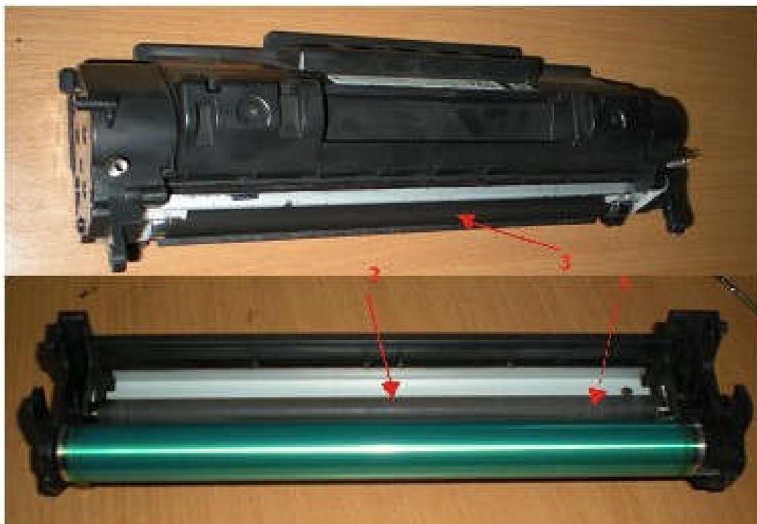
**Рисунок 206 –Картридж лазерного принтера в разобранном состоянии**
