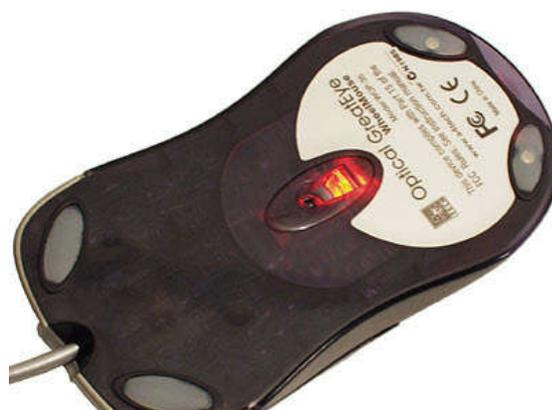
**Рисунок 147 – Оптическая мышь**
