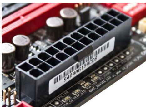
**Рисунок 13 – Разъем, к которому подключается блок питания**
