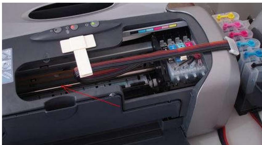
**Рисунок 198 – Направляющая каретки струйного принтера**
