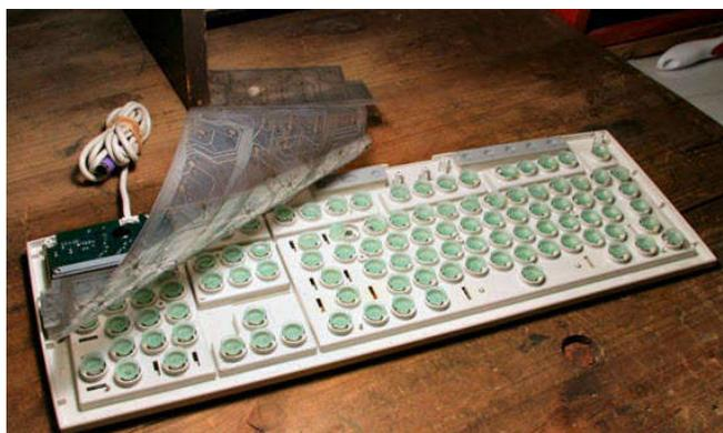
Рисунок 134 – Устройство мембранной клавиатуры
