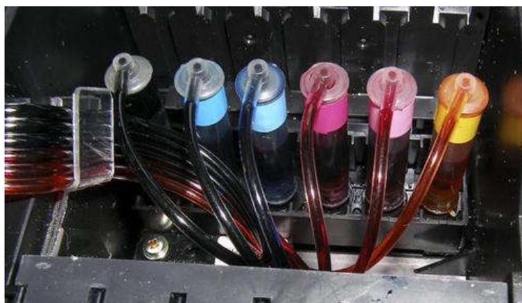
**Рисунок 201 – Общий вид капсульной СНПЧ**
