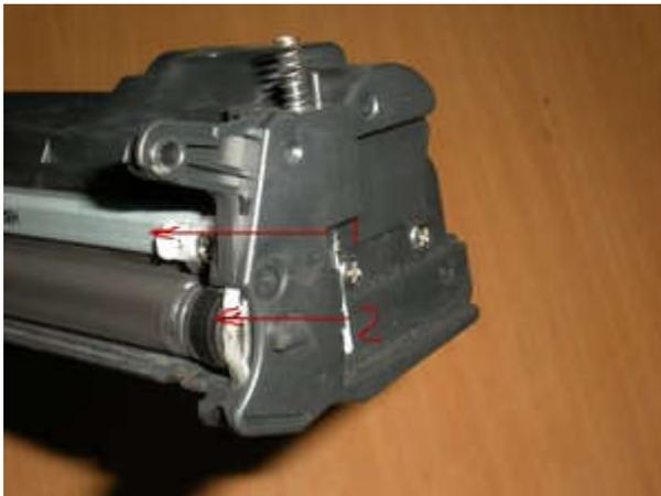
**Рисунок 216 – дозирующее лезвие (1) и дозирующие втулки (2)**
