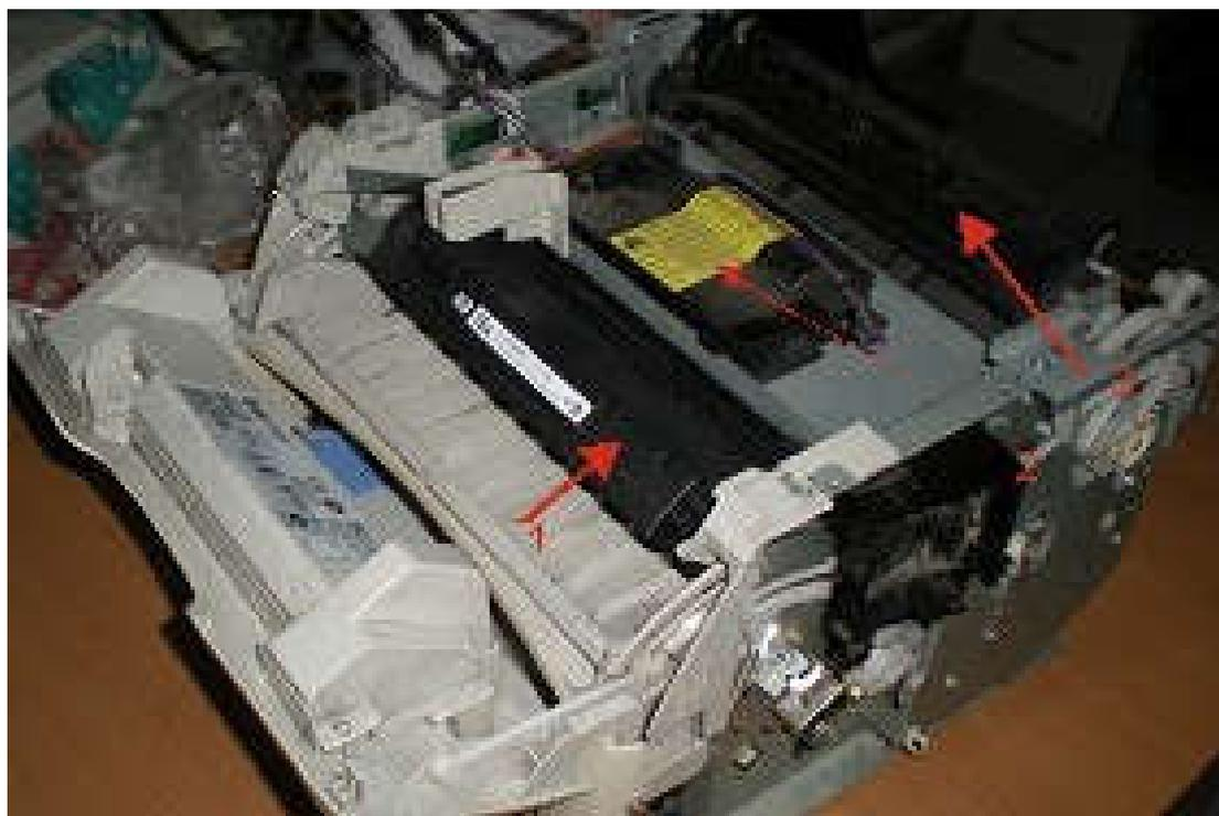
**Рисунок 204 – Лазерный принтер HP 1200 со снятой облицовкой**
