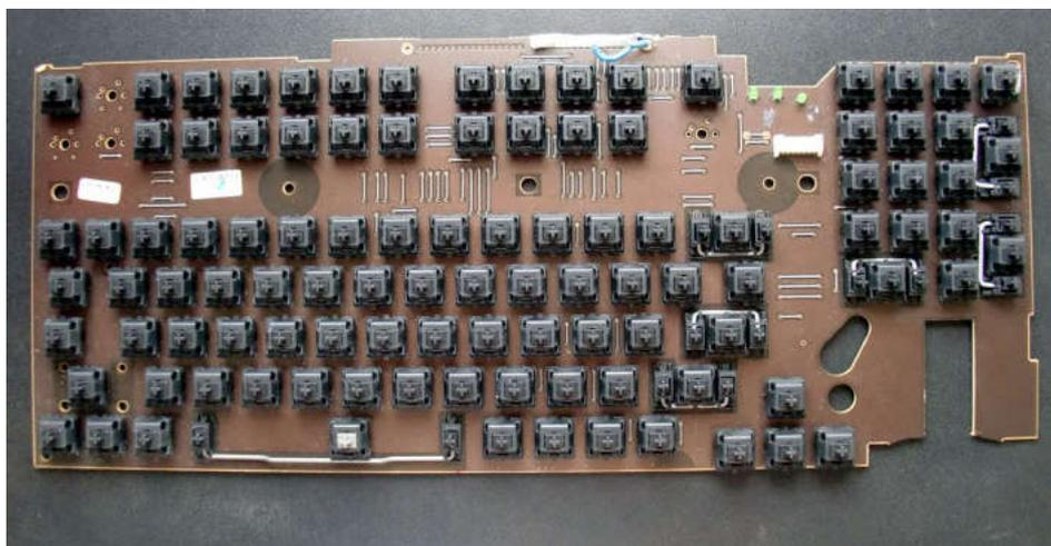
**Рисунок 137 – Клавиатура в разобранном виде**
