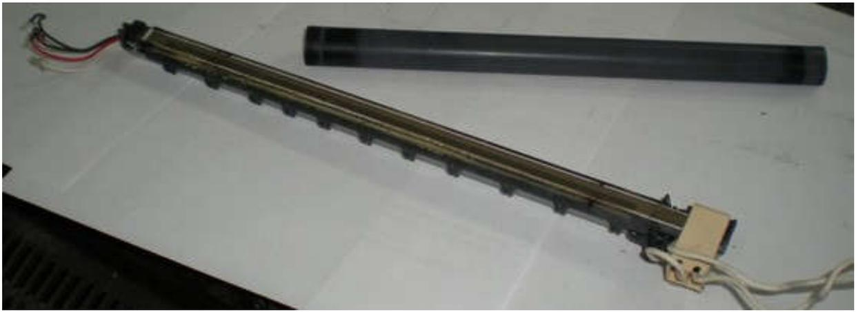
**Рисунок 209 – Нагревательный элемент и термопленка**
