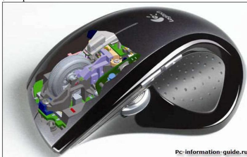
**Рисунок 141 – Устройство компьютерной мыши**
