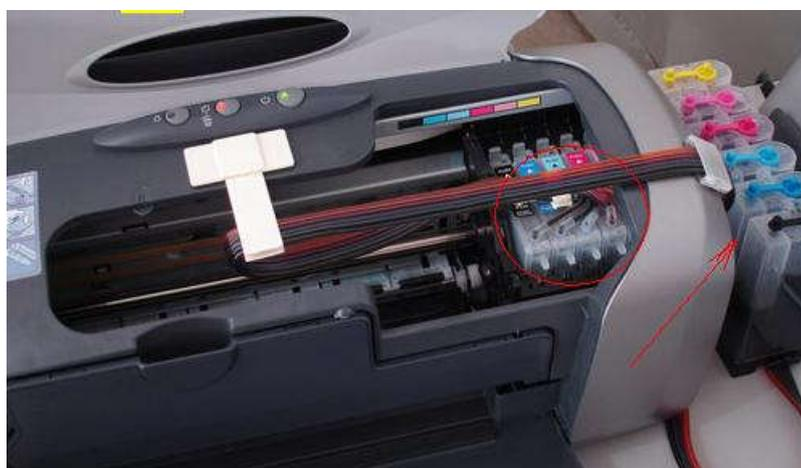
**Рисунок 196 – Печатающая головка с интегрированным картриджем (обведена кругом). Стрелкой показана установленная система СНПЧ**
