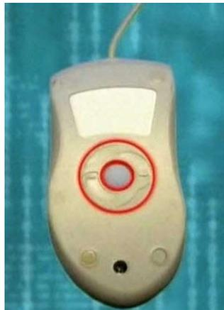
**Рисунок 143 – Механическая мышь**
