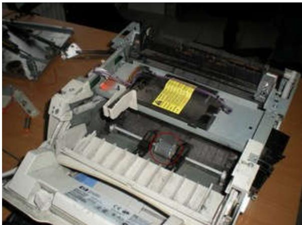
Рисунок 217 – Механизм подачи tray 1 (обведен красным)
