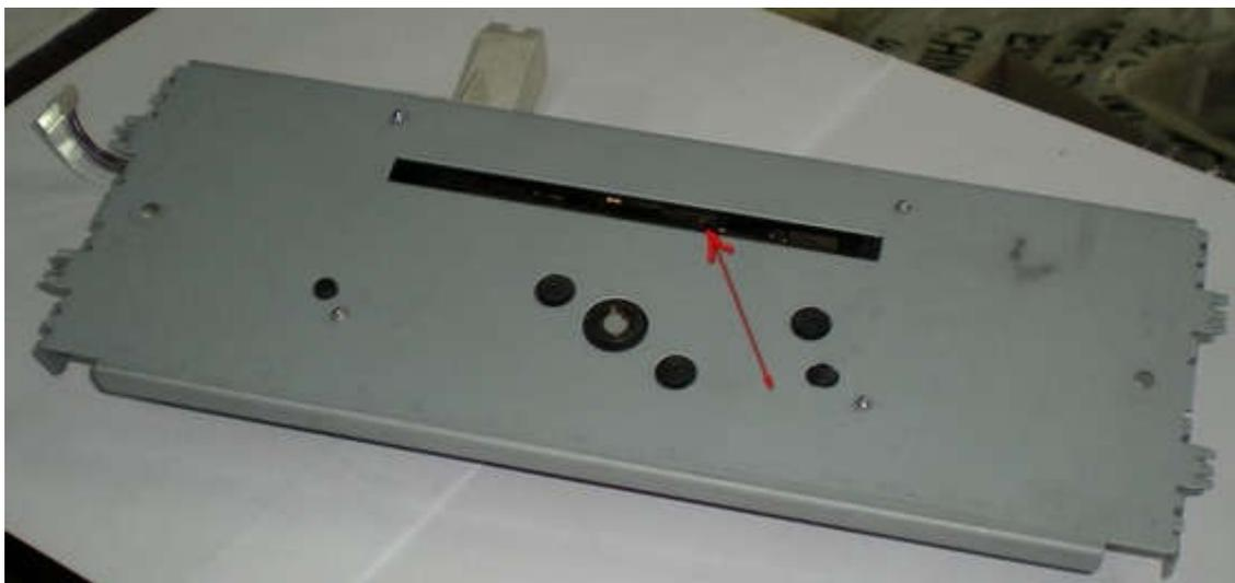
**Рисунок 219 – Щель главного зеркала (вид снизу)**
