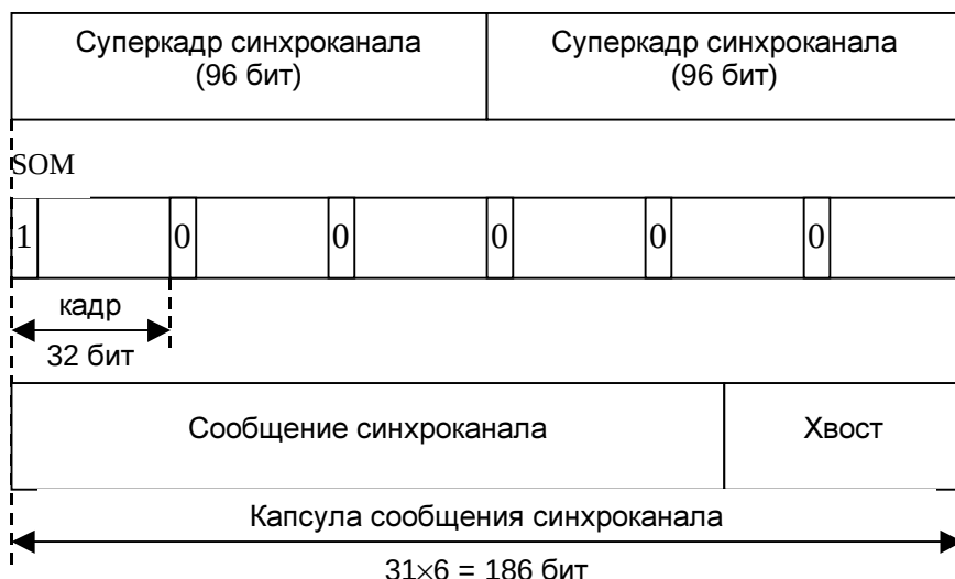
Рис. 7.15. Структура кадров канала синхронизации
