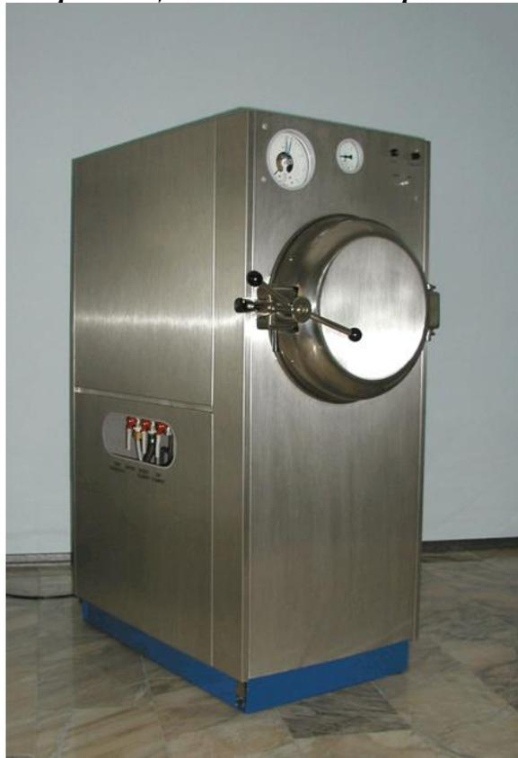
Совместное действие высокой температуры и давления пара обеспечивает особую эффективность данного способа. При этом погибают и вегетативные клетки, и споры микроорганизмов. Установлено, что споры большинства микроорганизмов не выдерживают и 5-минутную экспозицию в насыщенном паре при 121 °С. Стерилизацию текучим паром под давлением осуществляют в автоклавах.
