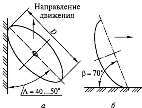
Рис. 4.21. Схема установки сферического диска на плуге:
