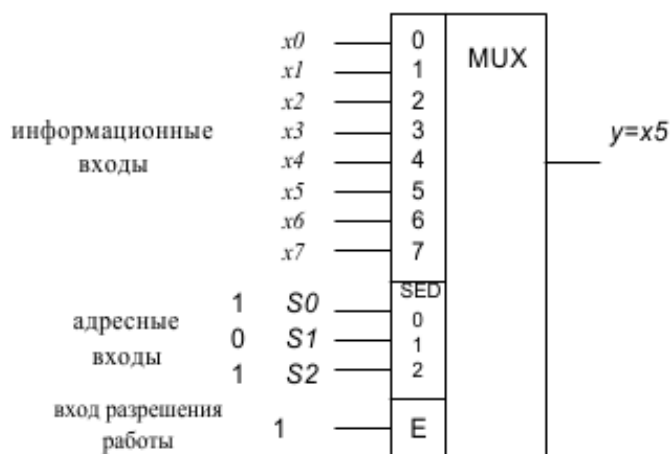
Рисунок 26. Мультиплексор
