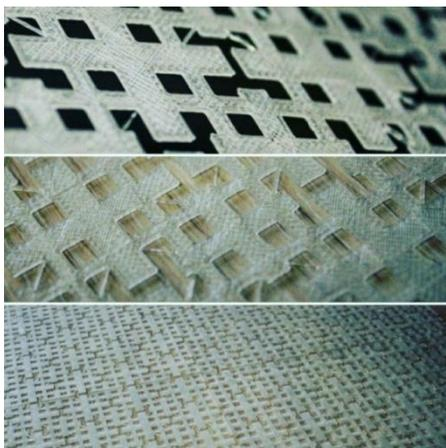
Рисунок 1. топология полимерной пространственно-неоднородной подложки полученной с помощью трехмерной печати
