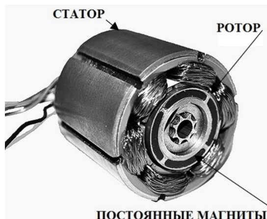
Рис.1. Конструкция вентильного двигателя фирмы “BEI KIMCO”
