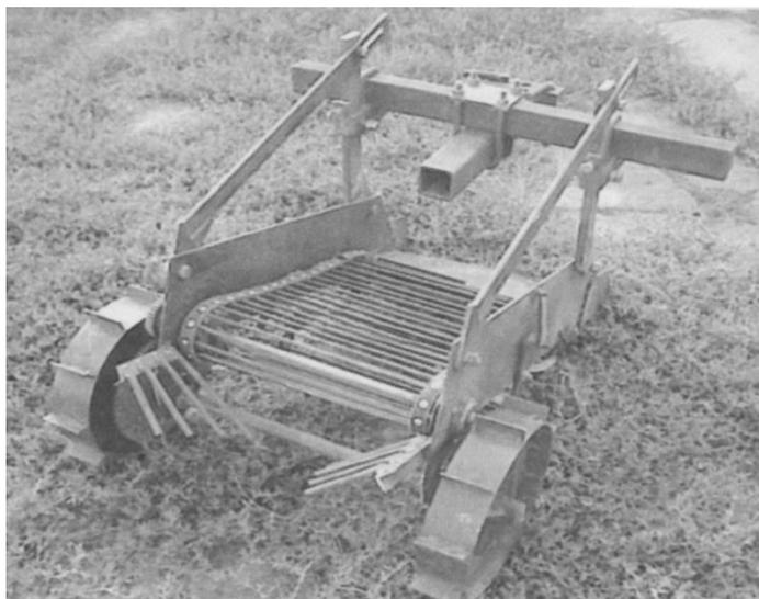
Рис. 4. Общий вид транспортёрной картофелекопалки
