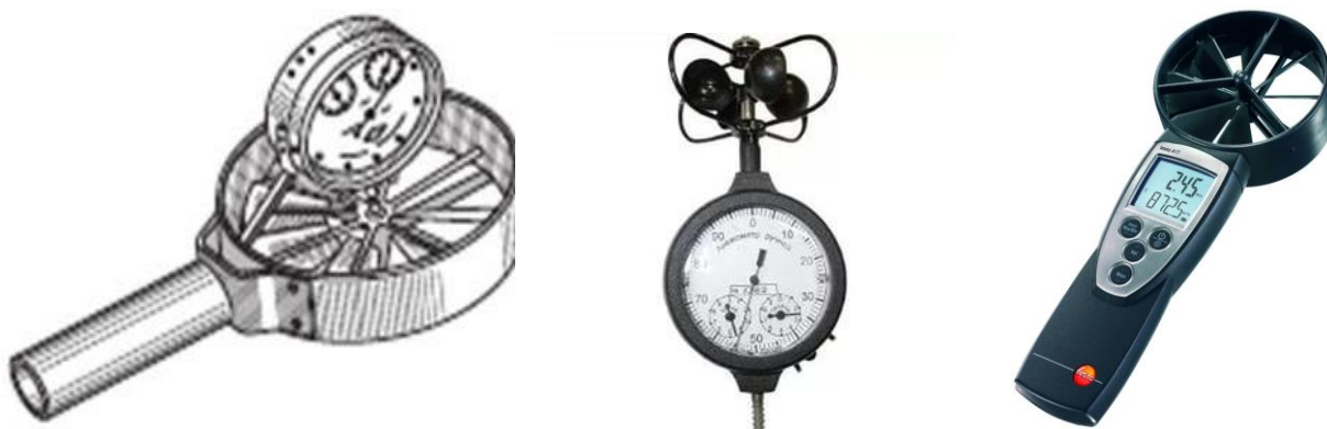
Рисунок. Анемометры: крыльчатый, чашечный, электронный.
