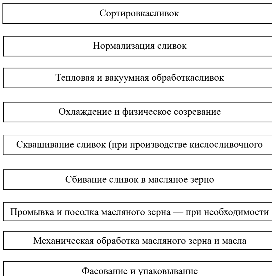
Рисунок 1 – Технологическая схема производства сливочного масла способом сбивания сливок
