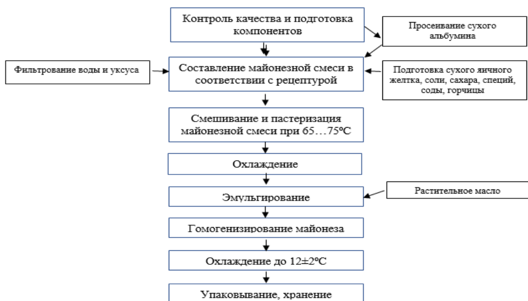
Рисунок – 1 Технологическая схема производства майонеза с альбумином
