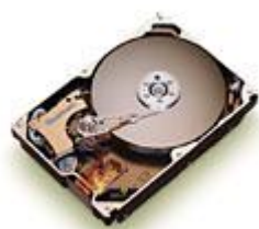
Рис. 1. Жесткий диск со снятой крышкой корпуса.
