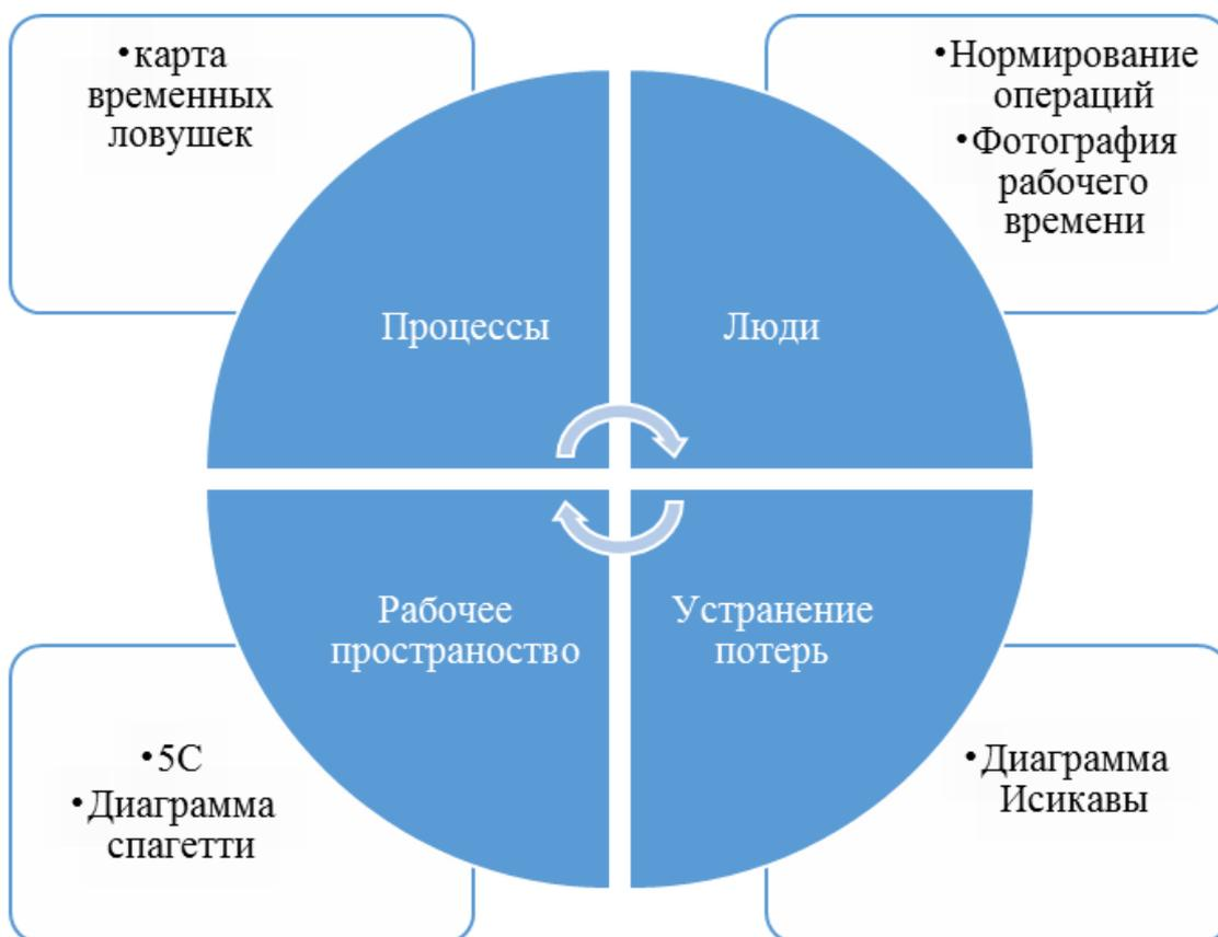
Рисунок 5. Матрица инструментов бережливого производства
