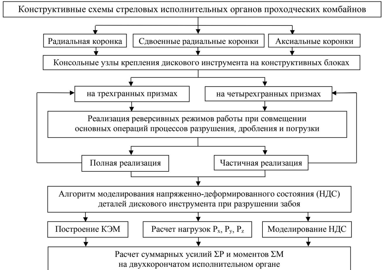
Рисунок 2.12. Этапы обоснования параметров конструктивных блоков дискового инструмента на исполнительных органах
