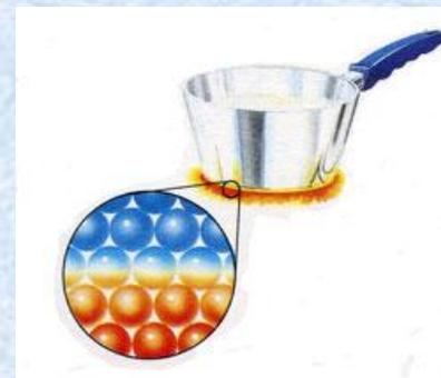
**Явление теплопроводности** заключается в самопроизвольном переносе кинетической энергии (теплоты) и *продолжается пока существует градиент* (разница) *температур*. Перенос теплоты (теплопроводность) подчиняется **закону Фурье:**
