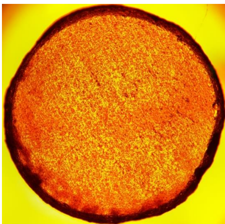
Рисунок 2. Структура ЖИГ-ГГГ в микроскопе "Микромед 3 вар. 3-20"
