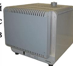
Муфельная печь подключается непосредственно к внешнему автоматическому выключателю или силовому шкафу. Допускается подключение муфельной печи в сеть посредством вилки и розетки. После подключения можно приступать к работе, предварительно ознакомившись с правилами техники безопасности при работе с муфельной печью.
