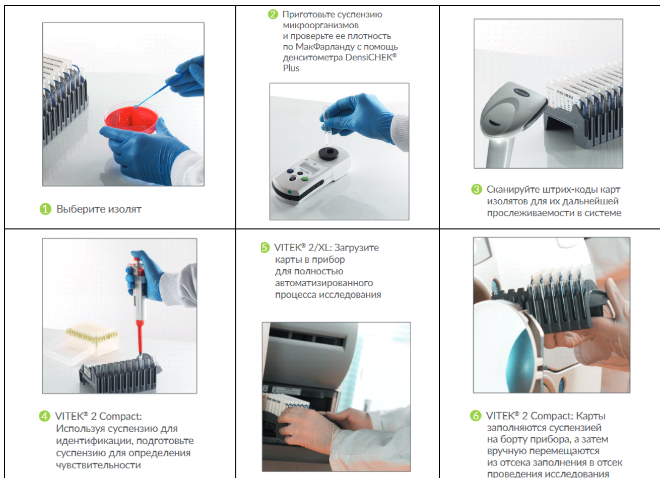
Рисунок 2. Принцип работы на анализаторе VITEK® 2 Compact
