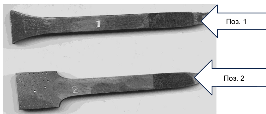
Рисунок 1. Изображение сравниваемых образцов сплавов, в графическом формате .jerg. Поз.1, Поз.2 – «шейки».
