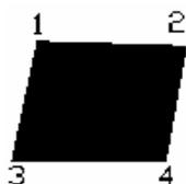
Две последние точки определяют первую сторону следующего многоугольника. Запросы *Третья точка* и *Четвертая точка* будут повторяться. После указания этих точек к исходной фигуре присоединяются дополнительные треугольные и четырехугольные фрагменты.
