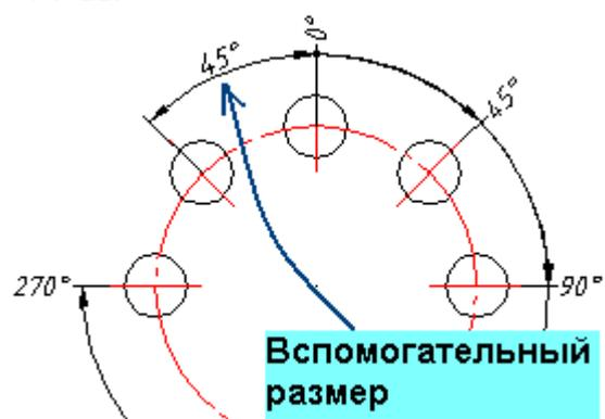
При простановке цепочки угловых ординатных размеров для базового размера со значением ноль градусов необходимо указать выносную линию вспомогательного размера. Вспомогательный размер должен быть проставлен заранее
