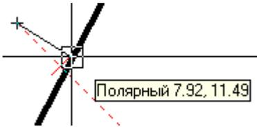
Работа полярной привязки так же, как и режим ОРТО, базируется на угле координатной системы.
